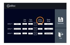
Im Feld "Sirup Prozent" kann die Konzentration des Sirups im Getränk erhöht oder reduziert werden. Wir empfehlen die voreingestellten Werte beizubehalten.
