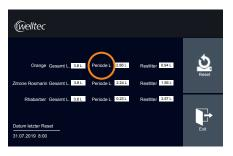
19 Tippen Sie auf die Taste "Periode L" der Sorte, die ausgetauscht wurde. Damit setzen Sie den Sirup-Zähler dieser Sorte auf Null.
