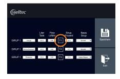
Mit dem folgenden Schritt sorgen Sie dafür, dass der Sirup-Rest aus dem Schlauch fließt und warmes Wasser nachgezogen wird.
