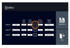
Um die Leitungen wieder mit Sirup zu befüllen, tippen Sie einmal auf die Taste Ti. Tippen Sie ein zweites Mal auf die Taste Ti sobald purer Sirup aus dem Getränkeauslauf fließt. Dadurch stoppen Sie die Abgabe von Sirup.
