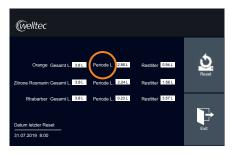
Tippen Sie auf die Taste "Periode L" der Sorte, die ausgetauscht wurde. Damit setzen Sie den Sirup-Zähler dieser Sorte auf Null.
