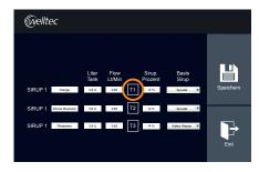
Drücken Sie die Taste T1, wenn der neue Kanister zur Sirup-Anschluss 1 gehört (Taste T2 bei Sirup-Anschluss 2 bzw. Taste T3 bei Sirup-Anschluss 3). Sobald reiner Sirup ohne Wasserreste aus dem Getränkeauslauf fließt, stoppen Sie den Vorgang aktiv, indem Sie erneut das Feld T1 (T2 oder T3) drücken.
